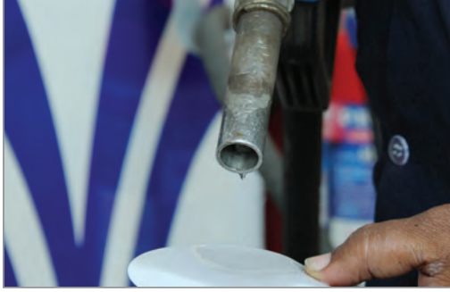
चित्र. 2.1.14. नोजल से फिल्टर पेपर पर पेट्रोल की एक बूंद डालें
