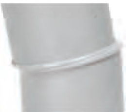
चित्र 2.5.22 गलत संरेखण/अनुचित "उच्च-निम्न" पाइप संरेखण को दर्शाता है।
