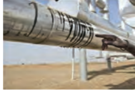
चित्र 4.3.31 तीसरे पक्ष के हमले के कारण पाइपलाइन में रिसाव
