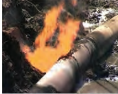
चित्र. 4.3.34 टूटने के कारण पाइपलाइन विस्फोट
