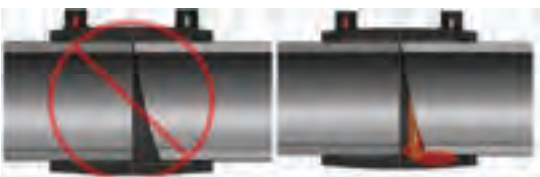
चित्र 2.6.89 चौकोर कट की कमी के कारण पाइप के अंदर पिघलन का जाना
