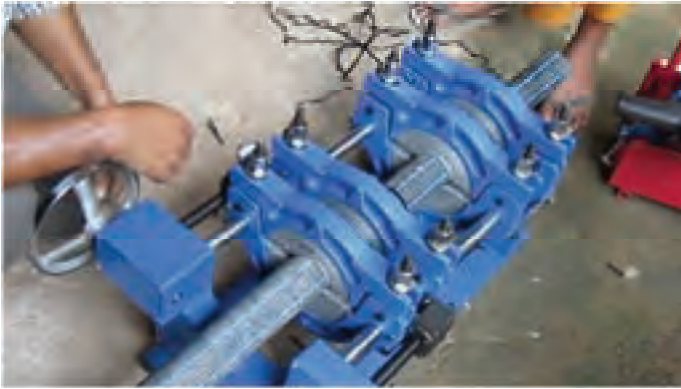
चित्र 2.5.4 हिलने वाले क्लैम्प के साथ पाइप को समर्थन
