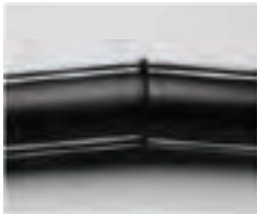
चित्र 2.5.22 गलत संरेखण/अनुचित "उच्च-निम्न" पाइप संरेखण को दर्शाता है।
