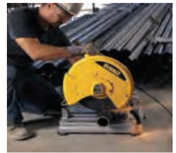
चित्र 1.7.33 काटने और किनारे की तैयारी के लिए चित्र
