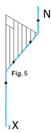
चित्र 1.2.14 रोलिंग और पूर्व की ओर चलने के साथ पाइपिंग का सममितीय दृश्य
