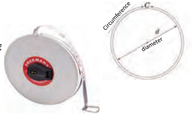
चित्र. 1.3.8 मापने वाले टेप का उपयोग करके परिधि मापना
