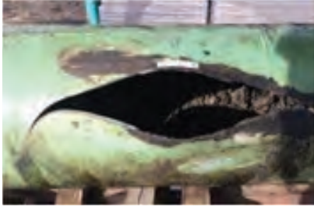
चित्र 4.3.30 शिथिल दरार के कारण पाइपलाइन का टूटना।
