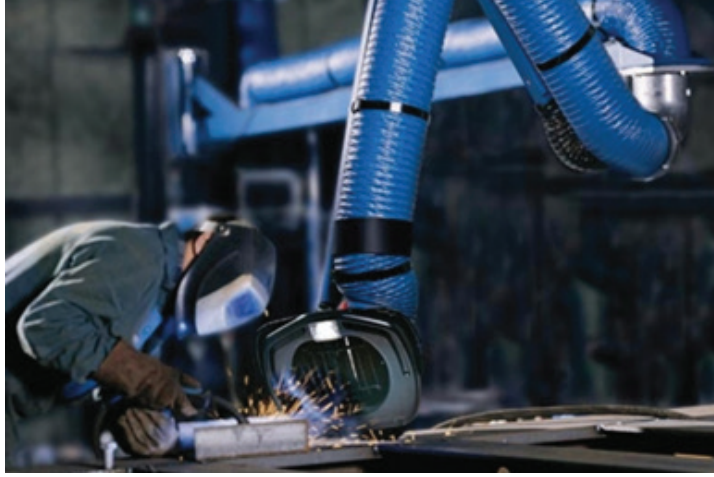
चित्र 7.1: लोकल इग्जॉस्ट वेंटिलेशन (Local Exhaust Ventilation)
