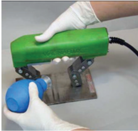
चित्र 4.15.1_7: मैग्नेटिक पार्टिकल टेस्टिंग (Magnetic particle testing)
