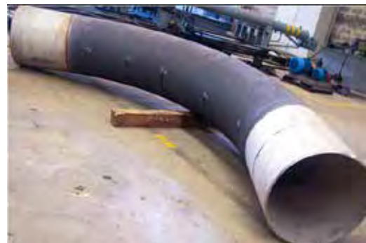
2.4.7 Pipe Hot Bend
