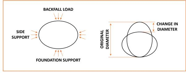
Fig: 2.1.12 Flexible Pipe
